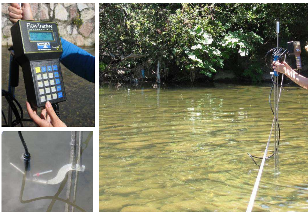
Fotografía 10-2.- Realización de aforo desde Puente de Sama, mediante equipo Flowtracker.
